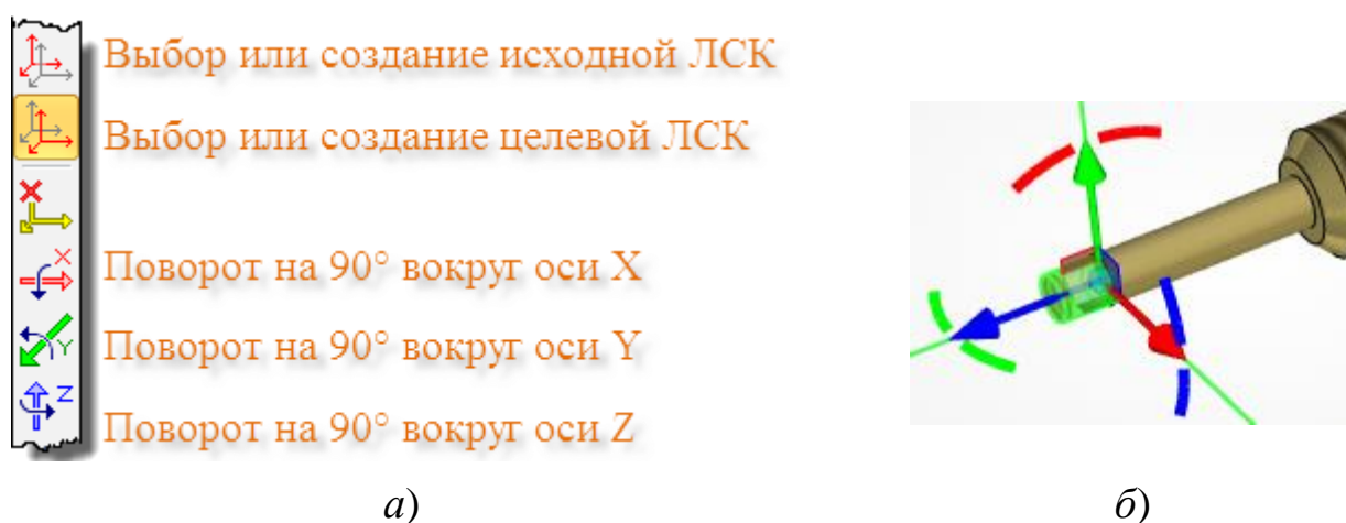
Рис. 3.1 – Позиционирование 3D фрагмента: а – команды Автоменю; б – манипуляторы
