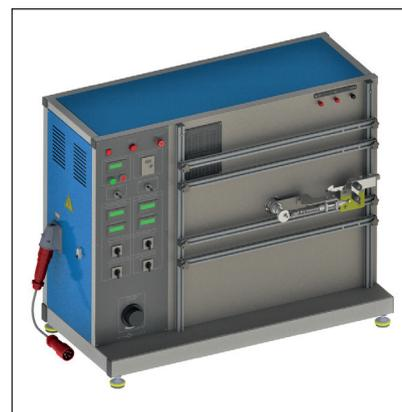
Рис. 6. Установка для испытания замка двери шахты лифта на подтверждение долговечности и испытания электрического устройства безопасности
