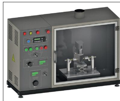
Рис. 17. Установка для определения трекинговости электроизоляции во влажной среде кинга (токопроводящих мостиков между поверхностью электроизоляции и электролитического раствора), и глубина эрозии не превышает 2 мм. Испытание проводится при напряжениях до 600 В.
