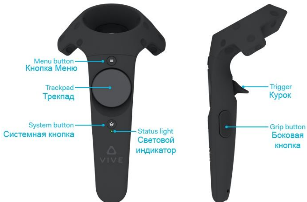
Рисунок 1.2 - Основные элементы контроллеров
