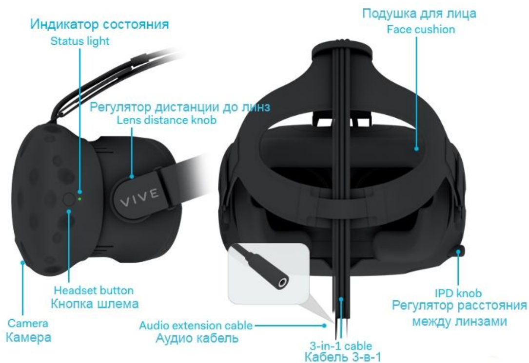
Рисунок 1.1 - Основные элементы шлема виртуальной реальности
