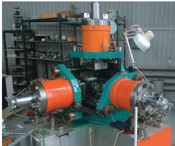
Рис. 1. Конструкция установки — прототипа проектируемой испытательной машины
