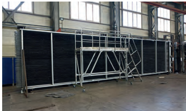
Рис. 2. Номинация «Эксперт». 2-е место. Холодильник-конденсатор азотоводородной смеси
