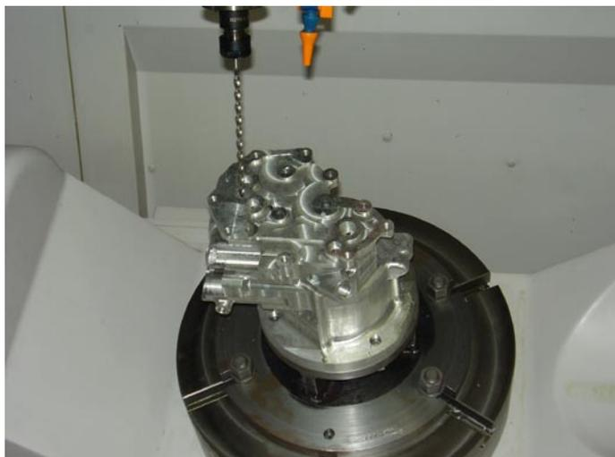
Рис. 7. Имитация 5D-сверления косоугольного канала
