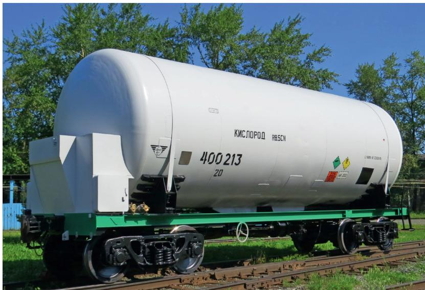
Вагон-цистерна 15-558с-04 для перевозки и хранения жидких аргона, азота, кислорода
