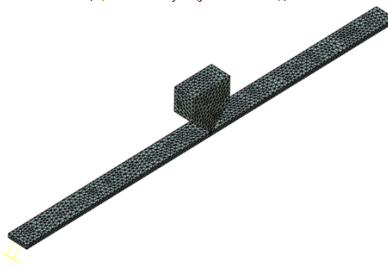
Рисунок 7.1-1 - Расчетная модель с нагрузками и закреплениями
