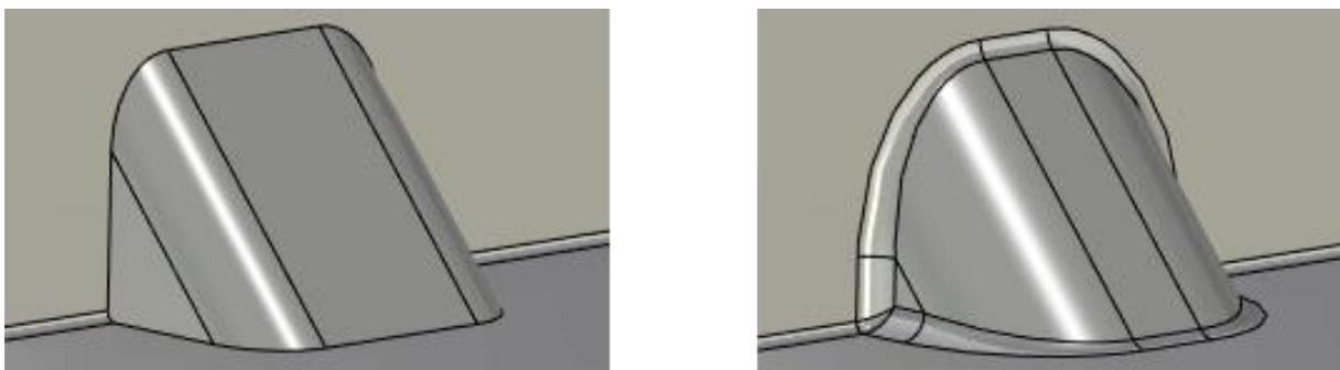
«**Смещение**». Задаёт положение ребра жёсткости. Смещение задаётся от ближайшей вертикальной грани. Если при создании ребра задана плоскость, то смещение отсчитывается в соответствии с положением плоскости.
