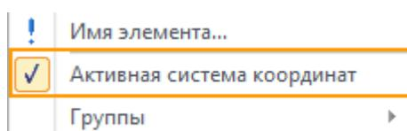
Координаты 2D элементов, заданных относительно системы координат, будут пересчитаны с учётом её положения.
