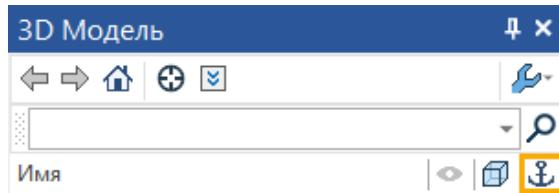
Колонка обеспечивает быстрое назначение и контроль зафиксированных тел.
