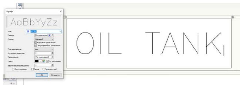
Траектория гравировки строится перпендикулярно грани, на которой создан текст. УП на гравировку траектории может формироваться в 2-ух осях (текст в плоскости перпендикулярный Z) и в 3+2 осях - позиционная обработка.
