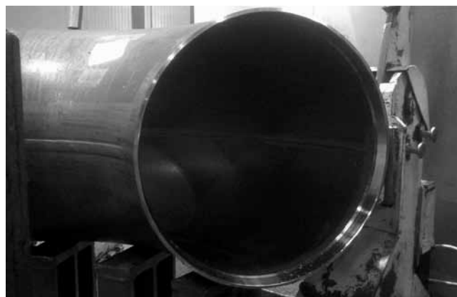
Рис. 1. Обработанная фаска на торце элемента трубопровода
